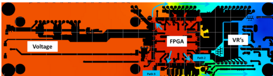
Figure 8 : Tracé de la tension dans une forme de masse montrant les chemins de retour du courant
